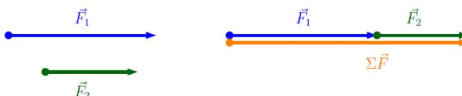
Si les deux forces  $\vec{F}_1$  et  $\vec{F}_2$  ont *même sens et même direction*, alors l'intensité (la norme, la longueur) de la résultante  $\vec{\Sigma F}$  est égale à la somme des intensités (normes) des forces composantes :
